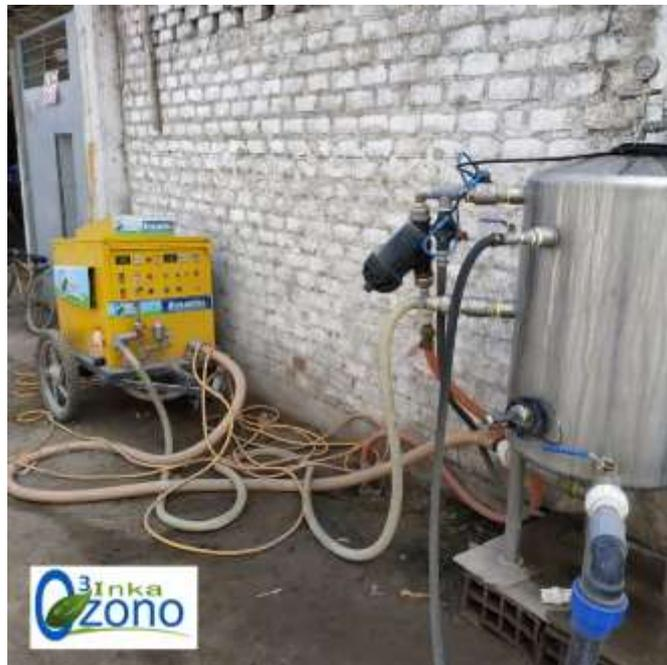
Figure 13 Sistema de Mezcla de Agua con Ozono para control de patógenos en Agricultura.
